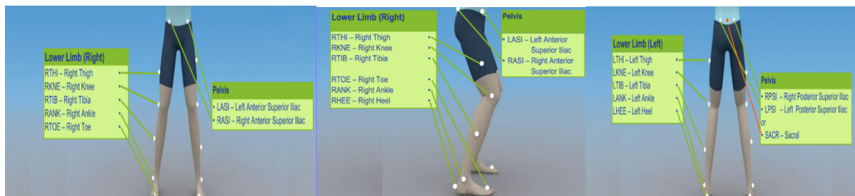
Fig 1: Frontal, høyresidig og posterior illustrasjon av markørpoppsettet for VICON (Vicon Plug- In Gait Product Guide, 2010).
