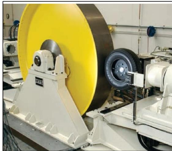
**FIGURE 3-C ROLLING RESISTANCE TEST MACHINE (MTS SYSTEMS, 2017)**
