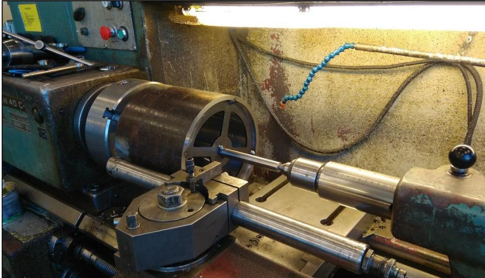
FIGURE 4-E THE ROLLER WELDED AND IN THE LATHE
