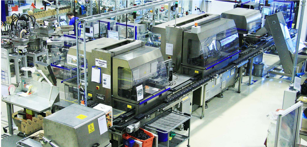
Figur 3.15: Pallettautomat levert av Mikron for produksjon av Threadlesskoblinger
