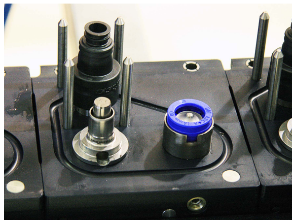
(b) Koblingshuset er plassert over støtterøret og blitt presset ned slik at de to komponentene sitter sammen
