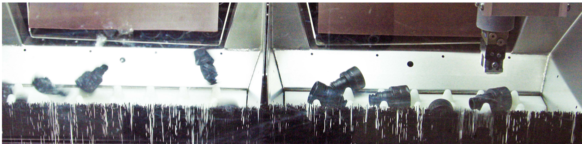
Figur 3.16: Nærbilde av en «Mikron Polyfeeder» som rister komponentene til venstre for å få riktig posisjonering samtidig som et vision-system lokaliserer deler i den høyre delen. En griper står klar til å montere lokaliserte komponenter
