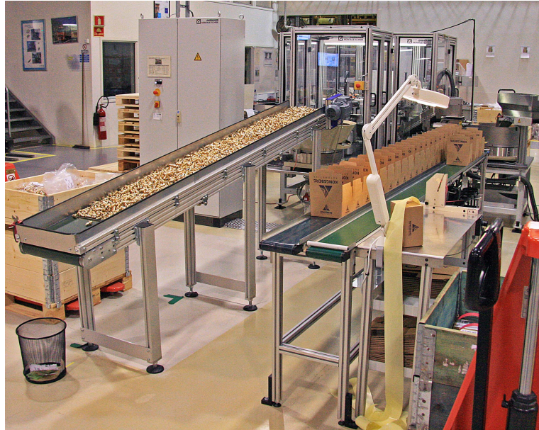
Figur 5.13: Manuell påfylling av komponenter med en relativt stor og arealkrevende buffer. Bildet er fra dagens produksjon
