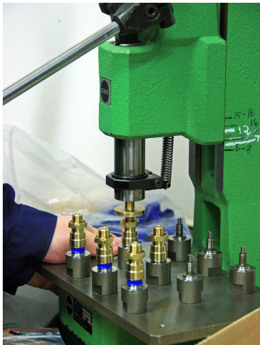
(a) Manuell montasje med ren visuell kvalitetskontroll. Det brukes spesielle fiksturer for de forskjellige produktene
