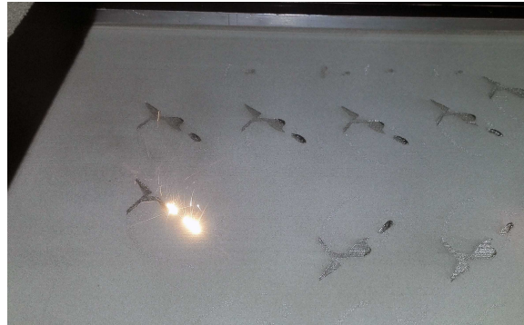
(b) Produksjon av griperfinger i metall
