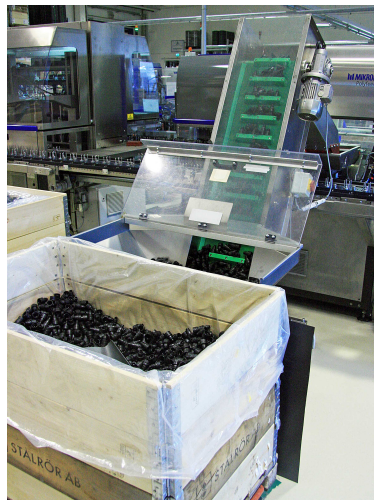
(b) Transportøren mates manuelt med komponenter fra pallen nede i det venstre hjørnet
