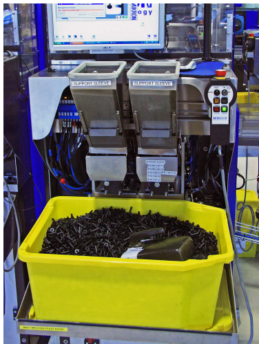
(a) Et system for manuell påfylling av støtterør til en MIKRON-maskin
