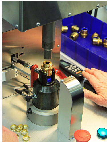
(b) Manuell montasje med en delvis automatisert presse. Pressen kvalitetssikrer koblingen ved bruk av induktive og optiske sensorer
