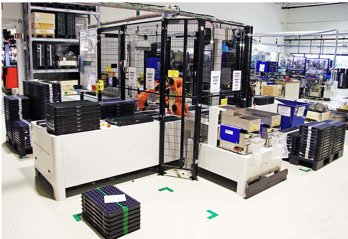
Figur 3.17: Bilde av montasjecellen for manifolder. De svarte boksene er blistere for oppbevaring av KARtridgekoblinger. Sentralt til høyre vises to flexfeedere i aluminium
