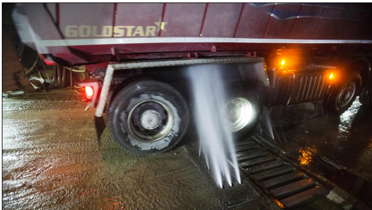
Bilde 2 Spyling av understell (Teknisk Ukeblad, 2016)
