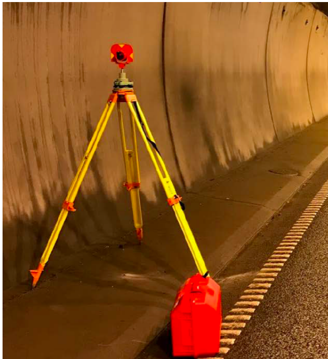
Figur 4.5: Det var rigga opp tre rundprisme i tunnelen under forsøka, plassert over kvar sine fastmerke. Foto: Christer Gabrielsen, SVV.
