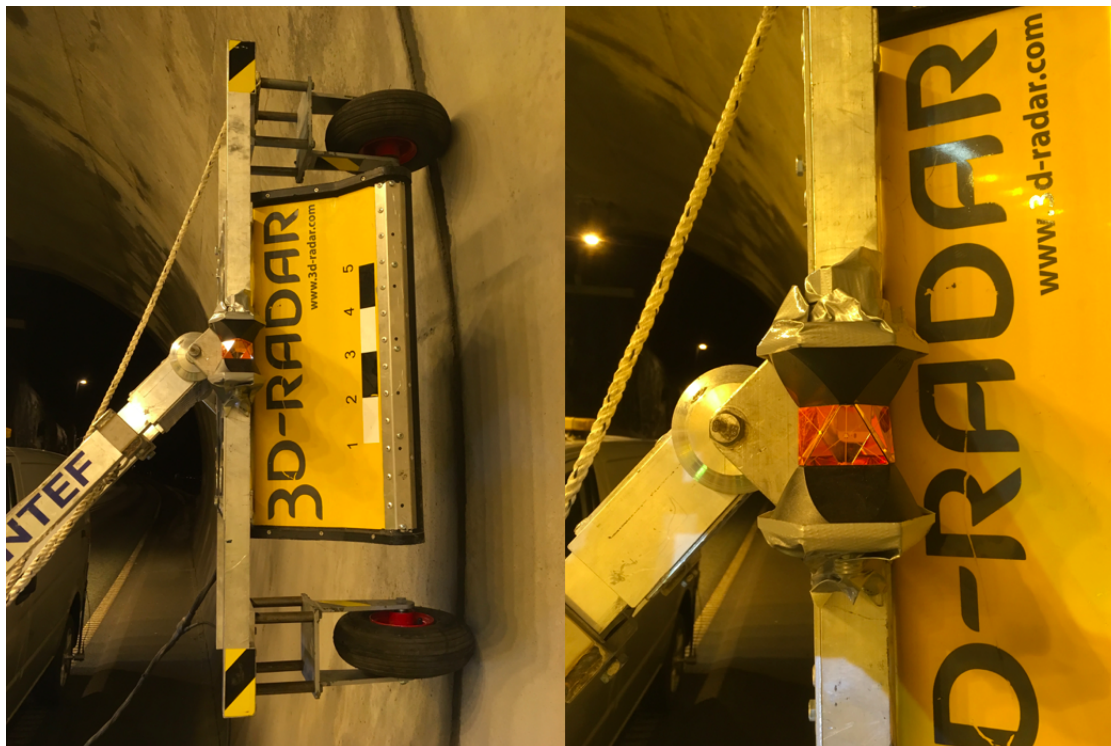
Figur 4.4: 360-gradersprismet, som totalstasjonen følger for å oppnå kontinuerleg posisjonslogging undervegs, er festa midt på aksen til festebraketten for georadarantenna.
