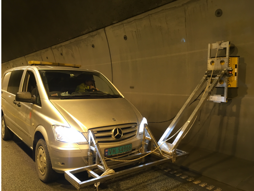
Figur 4.3: Georadarbilen har ein spesialtbygd festebrekett som georadarantenna er festa til. Ein kan òg sjå korleis antenna førast på hjul langs tunnelveggen.
