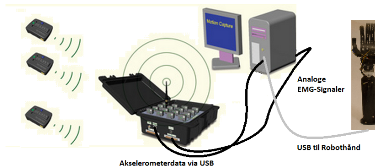
Figur 10: Figuren viser sammensetningen av maskinvarekomponenter som benyttes i dette prosjektet
