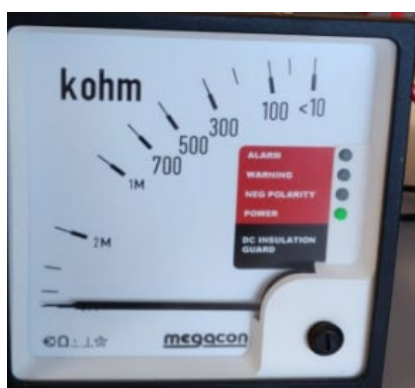
Figur 2: ingen tilkopling mellom jord og +V
