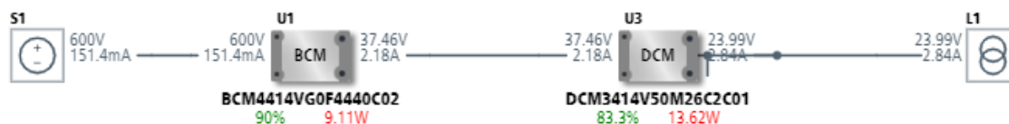
Figur 5 Utregning av effekt ved 8.5\Omega last
