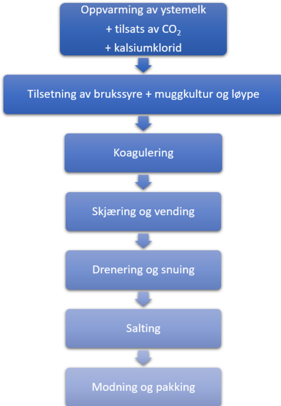
Figur 3.2: Flytskjema for Camembert ystet på prosesslaboratoriet på Akrinn NTNU
