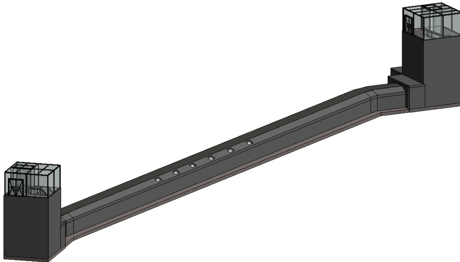
Figur 4-3-2: Modell av fotgjengertunnelen i Revit.
