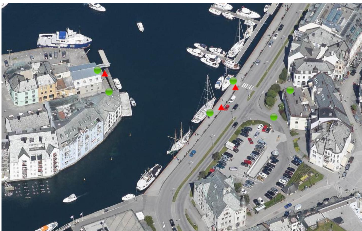
Figur 4-2-3: Oversikt over skanneposisjoner, og posisjon på prismene. Rød trekant er prisme, grønn sirkel er laser skanner.
