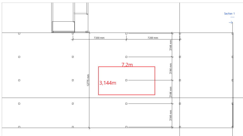
Figur 30 - Illustrasjon av belastningsareal, (Revit)
