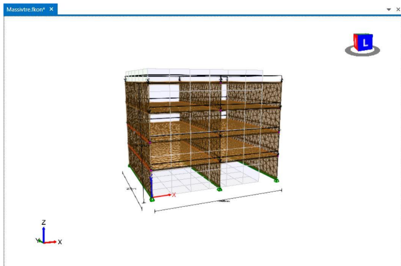
Figur 26 - Statisk modell, (Focus Konstruksjon)
