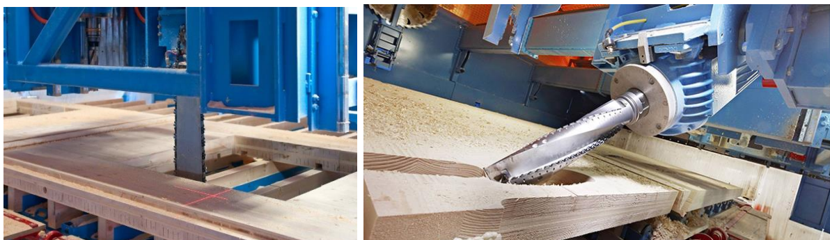
Figur 2.11: Elementer kuttet og freses (venstre: novatop-system.cz, høyre: clt.info)
