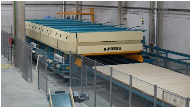
Figur 2.10: Lameller limes og presses (ledinek.com)
