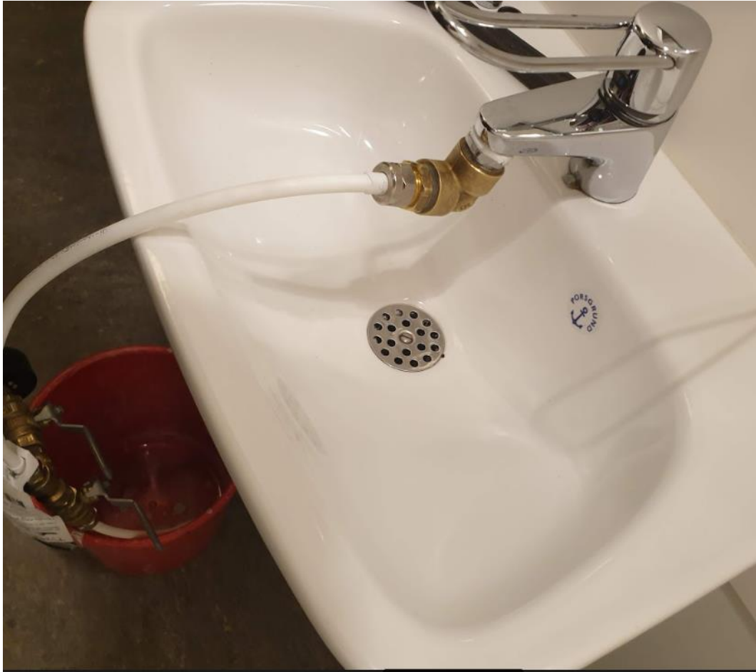
Figur 9 Egenprodusert forsøksinstrument tilkoblet servant og klar for å måle vannforbruk og trykk.
