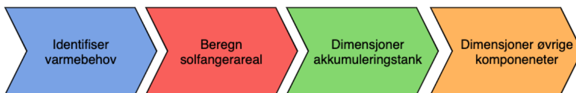
Figur 2.5: Fremgangsmåte ved dimensjonering av solvarmeanlegg [1]
