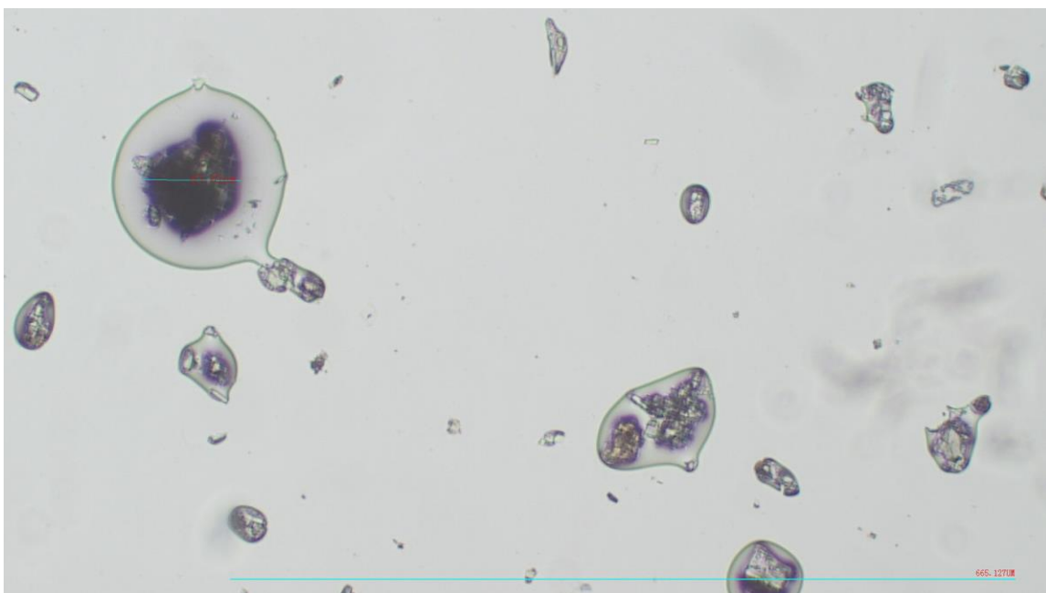
Figur 13: Støvdekkeprøve tatt i punkt 5. Forstørrelse x100. Foto: Bente Hellum.
