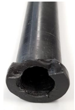
Figur 69 – Skade på foring
