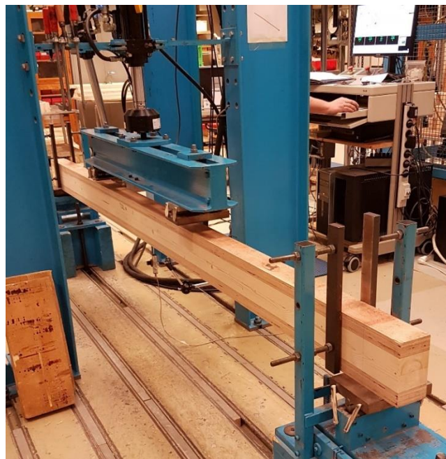
Figur 3.5: Testoppsett med gaffellagring og glidelager i ene enden – Foto: Mathilde Espelid
