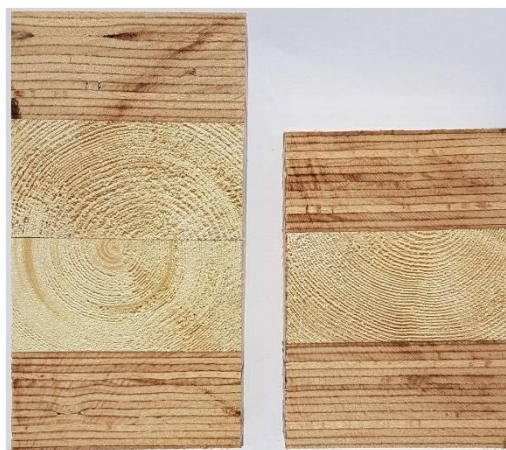
Figur 3.2: Tverrsnitt av valgte testbjelker – Foto: Mathilde Espelid
