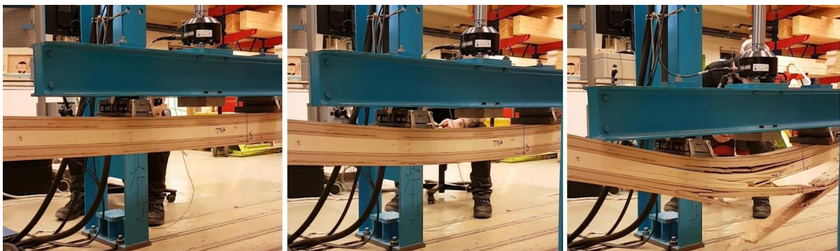
Figur 5.4: Bildeserie av testbjelke T15A som oppnådde størst bruddspenning – Foto: Mathilde Espelid
