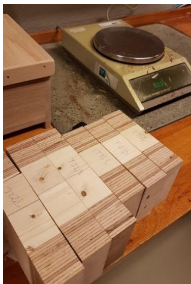
Figur 3.7: Prøvestykker for måling av fuktighet og densitet – Foto: Mathilde Espelid
