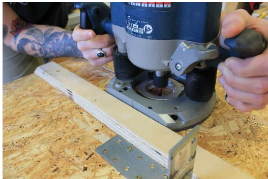
Figur 29: Montering av RF- og temperatursensor i sjikt mellom OSB og vakuumisolasjon
