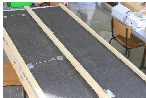
Figur 31: Montering av temperatursensor i sjiktet mellom asfaltplaten og utlekting for ytterkledning
