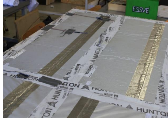
Figur 30: Montering av RF- og temperatursensor i sjikt mellom vakuumisolasjon og asfaltplaten
