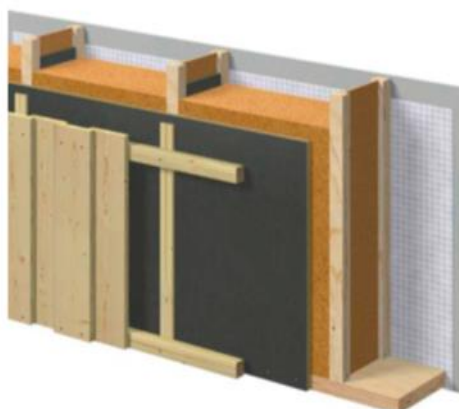
Fig. 1 Illustrasjon for typisk veggoppbygning med Hunton Vindtett
