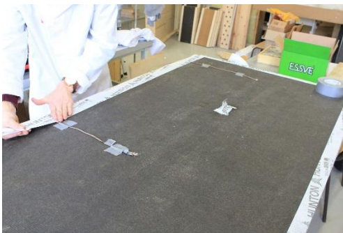
Figur 31: Montering av temperatursensor i sjiktet mellom asfaltplaten og utlekting for ytterkledning
