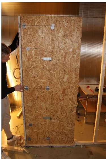
Figur 35: Visuell inspeksjon av overflate OSB-plate
