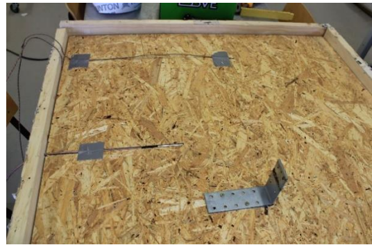
Figur 29: Montering av RF- og temperatursensor i sjikt mellom OSB og vakuumisolasjon
