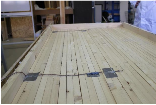
Figur 28: Montering av temperatursensor i sjikt mellom massivtre og OSB
