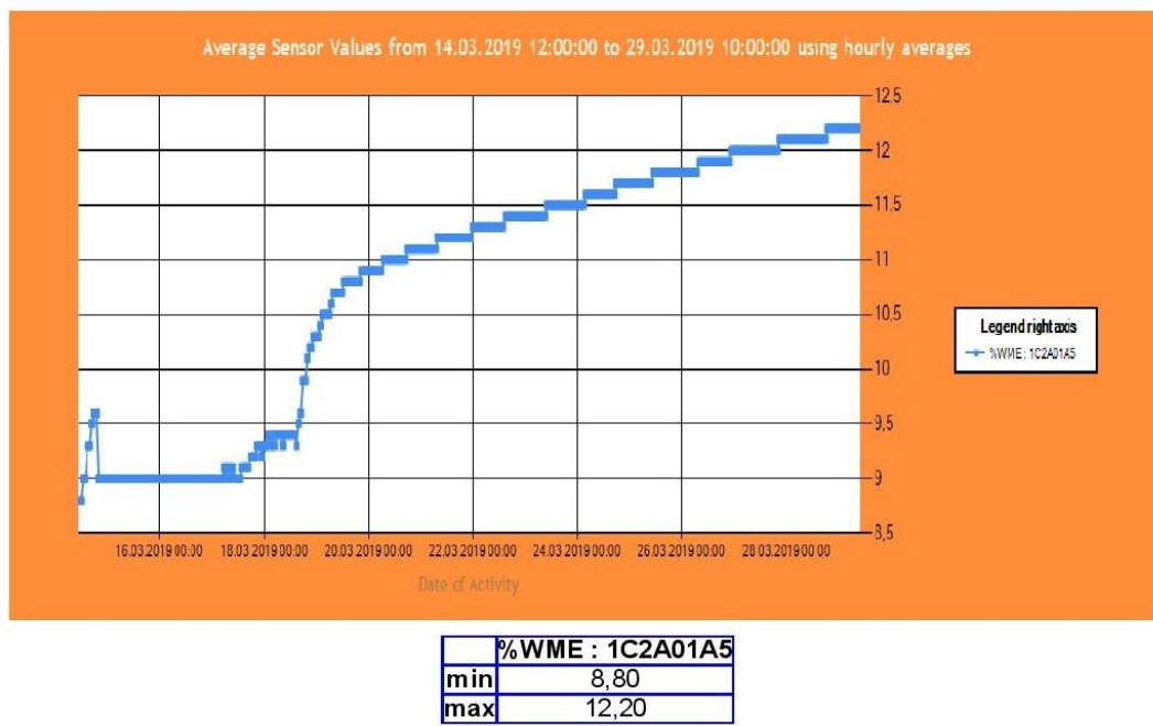
Figur 45: Omnisense diagram - Trefuktighet ytterkledning
