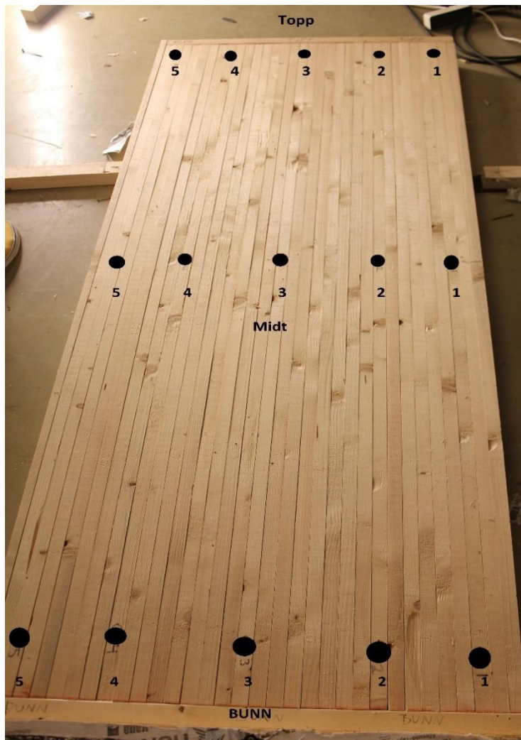
Figur 34: Viser hvor det er utført fuktmålinger. Her tydeliggjort i Microsoft Paint Merk: Plasseringene gjelder for samtlige sjikt
