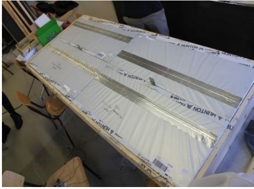
Figur 30: Montering av RF- og temperatursensor i sjikt mellom vakuumisolasjon og asfaltplaten
