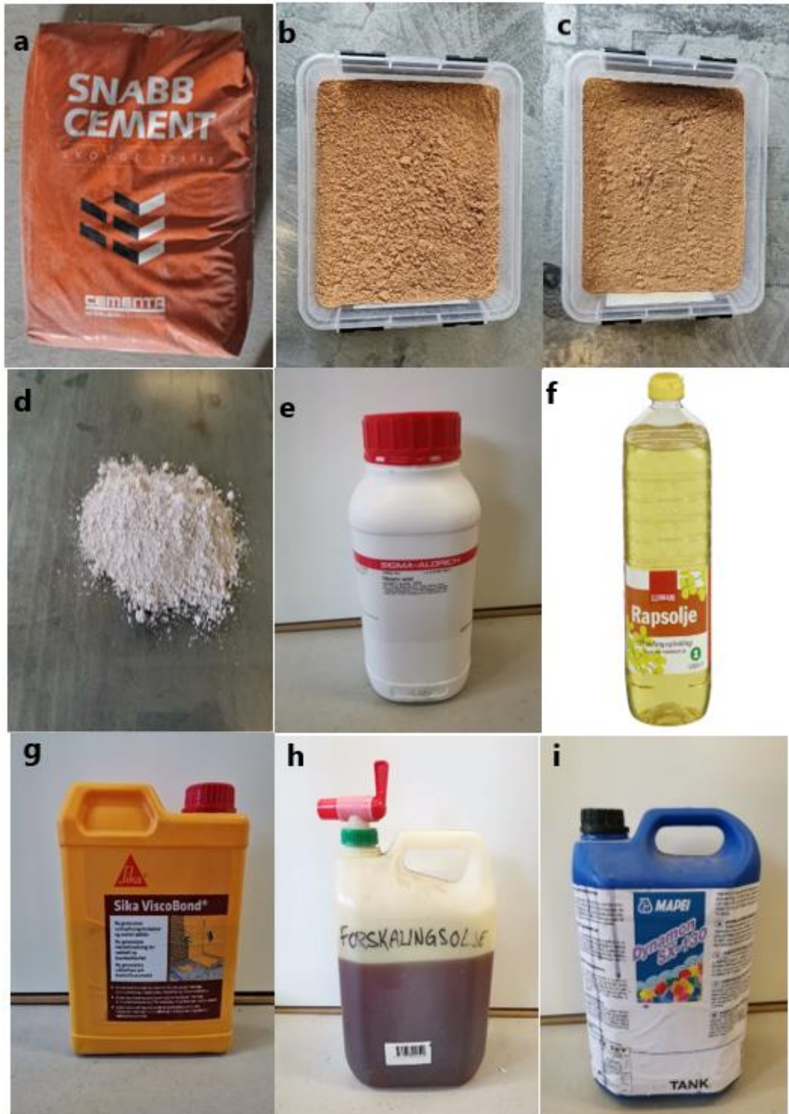
Figur 1: Materialvalg: a) Snabb cement b) Kalsinert blåleire c) Sintert blåleire d) Kalkstein e) Stearic Acid f) Rapsolje g) Sika ViscoBond h) Forskalingsolje i) Dynamon SX-130
