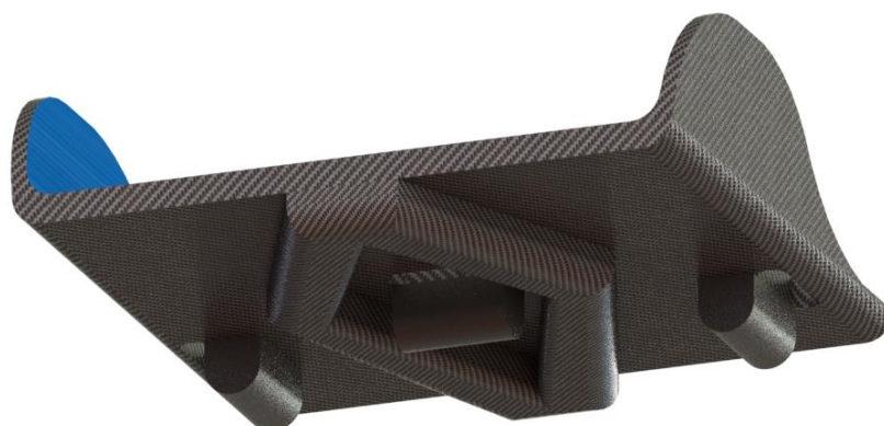
Figur 59: Resultat støtteramme - undersiden av seteplate
