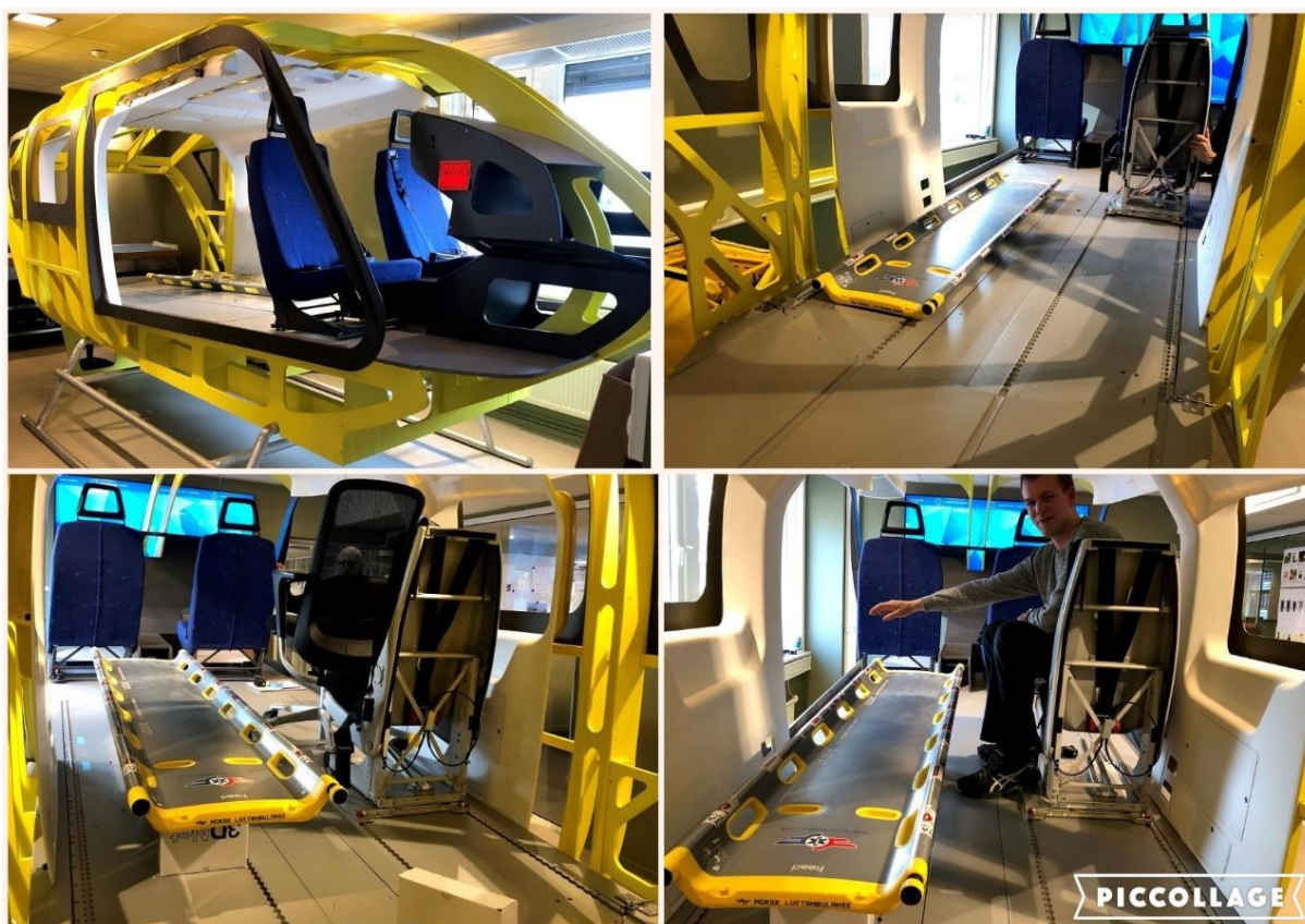
Figur 28: Mock-up av helikopter hos Stiftelsen Norsk Luftambulanse. Uprøving med kontorstol, heving av bære og forflytning av stol
