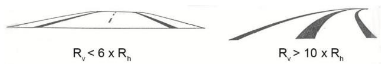
Figur 20: En liten konveks vertikalradius skjærer veien av. En tilstrekkelig stor vertikalradius gir det korrekte vegbildet (Vejdirektoratet, 2018b, s. 56)
