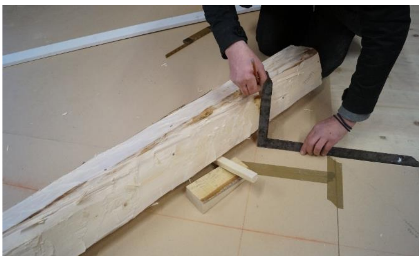
Bilde 109 Stokken kantes til to punkter på øvre og nedre kanten flukter, så merkes punktet på siden
