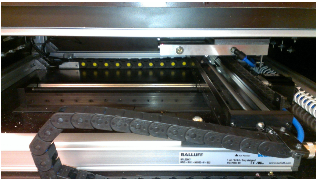
Figur 1.3: XY-bordet som brukes til å flytte waferprøven rundt i SiWa-Scan.
