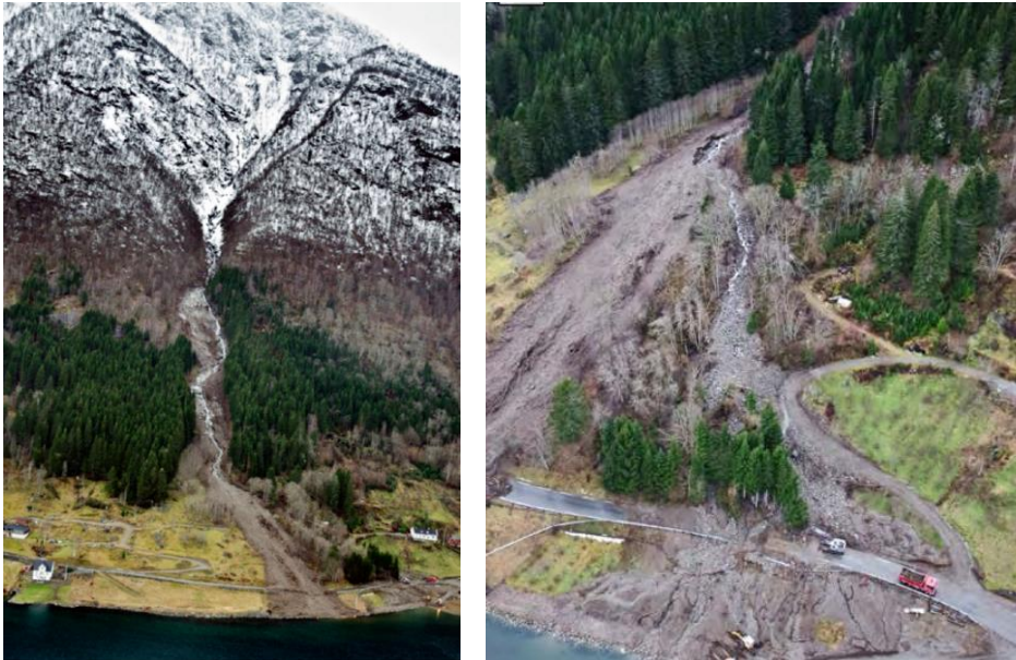
Figur 3.5: Bildene viser et flomskred som gikk ved Bakkevik i Skrednes i (Balestrand, Sogn og Fjordane) 26. desember 2011. Eksempelet viser hvordan gjentatte flomskred har erodert ut en ravineform i terrenget og avsatt sedimenter utover utløpsområdet, hvilket har skapt en vifteform (Bergheim, 2011ab).
