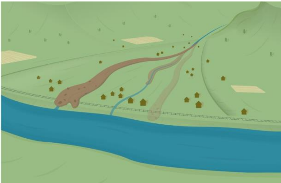
Figur 3.10: Erosjons- og skredmateriale som fraktes med elva og avsettes på bebygde ellevifter er en typisk situasjon som kan oppstå ved flomvannføring, og som kan føre til store skader. (Varsom, u.å.).
