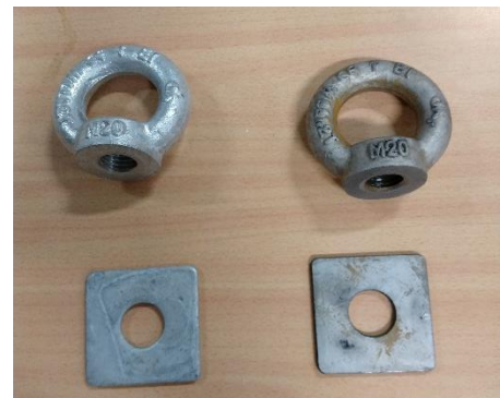
Figur 11: Til venstre kan en se firkantskiven og ringmutteren galvanisert, til høyre er begge delene strippet for sink belegget.
