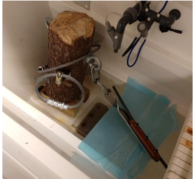
Figur 10: Stokken med alt av metall ferdig montert plassert i salttåkekammeret før testen starter
