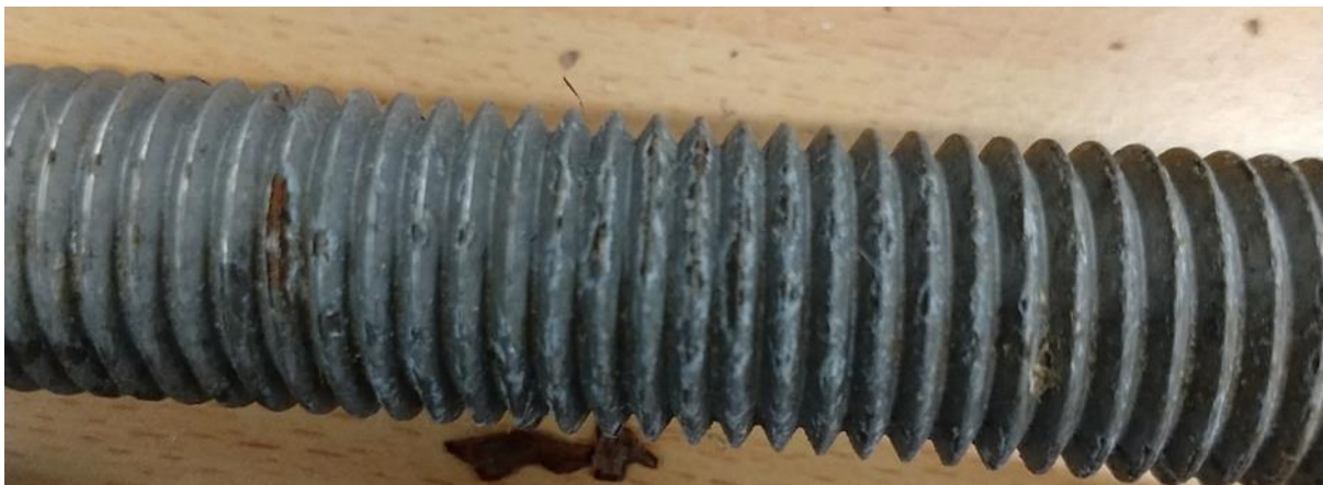
Figur 11: Skade på gjengestang som har stått i treverket i salttåkekammeret
