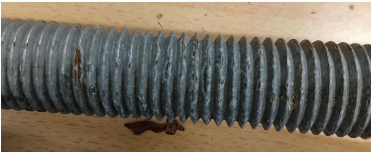
Figur 13: Gjengestang etter 30 dager i treverk i salttåkekammer som har opplevd korrosjonsskade på øvre gjenger som mangler sinkbelegg.
