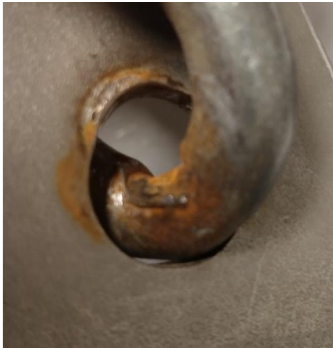
Figur 19: En maillon som har stått festet i en rustfri plate og har stått i strekk
