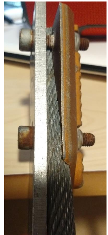
Figur 17: Easybrakett etter 30 dager i salttåkekammer
