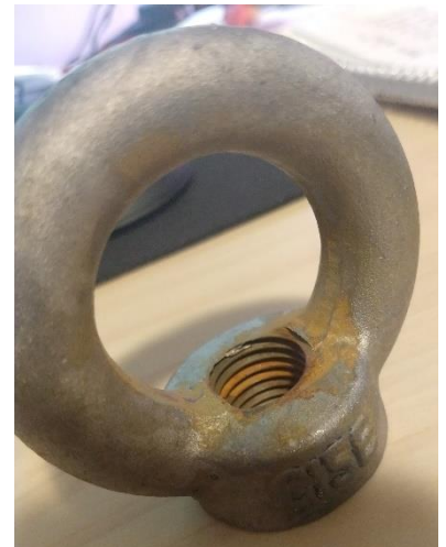
Figur 15: På innsiden av ringen og i gjengene er det dannet brune områder etter sinkbelegget ble strippet.
