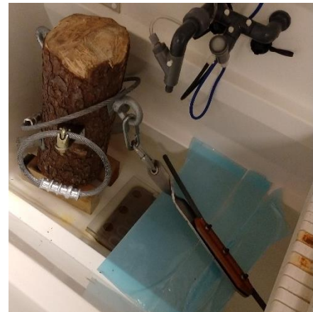
Figur 10: Trestokken med metallbitene som brukes i klatrepark monterert og plassert i salttåkekammer
