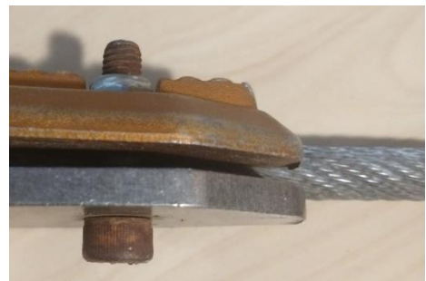
Figur 12: Galvanisk korrosjon på skruene i en easybrakett etter test i salttåkekammeret
