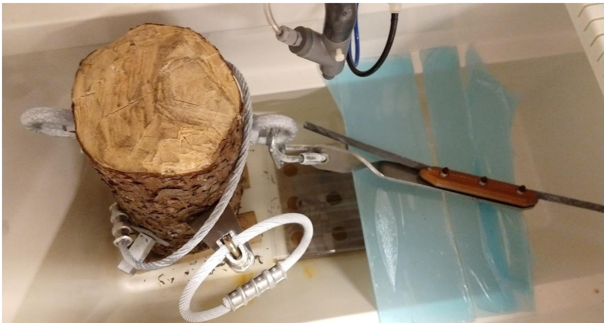
Figur 16: Prøven avbildet rett etter testen er avsluttet og salttåkekammeret er blitt åpnet
