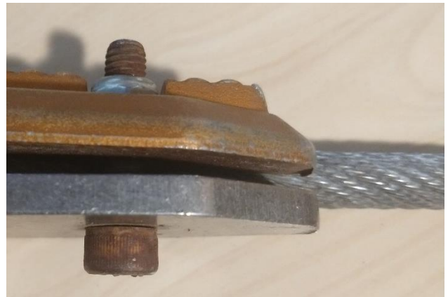
Figur 12: Easybrakett etter 30 dager i salttåkekammeret, kan se korrosjon av skruene samt hvit rust på vaieren.
