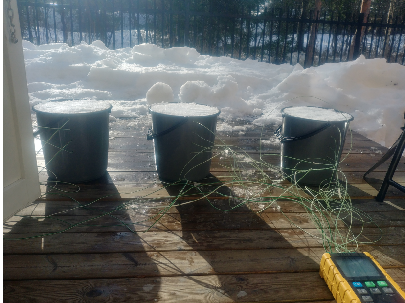
Figur 3.2: Bøtte med temperatursensorer i hull på 2, 6, 10 og 14 cm dybde.
