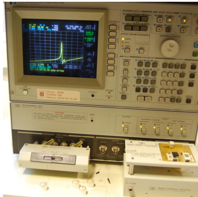
Figur 5.1 Karakterisering av transducere med HP 4194A Impedance/gain-phase analyzer.
