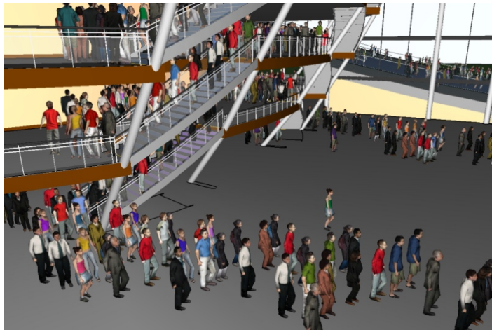
Figur 5: Rømningssimulering i Pathfinder (Illustrasjon: Thunderhead Engineering)
