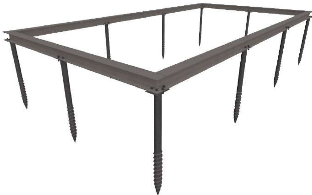
Figur 16. Skru fundamentet blir festet til en stålramme under hytta. Stålrammen er bygd opp av sveisede HE140A bjelker og er festet til bjelkelaget til hytta.
