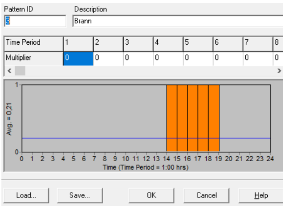
Figur 3.4: Variasjonskurve for brannuttak
