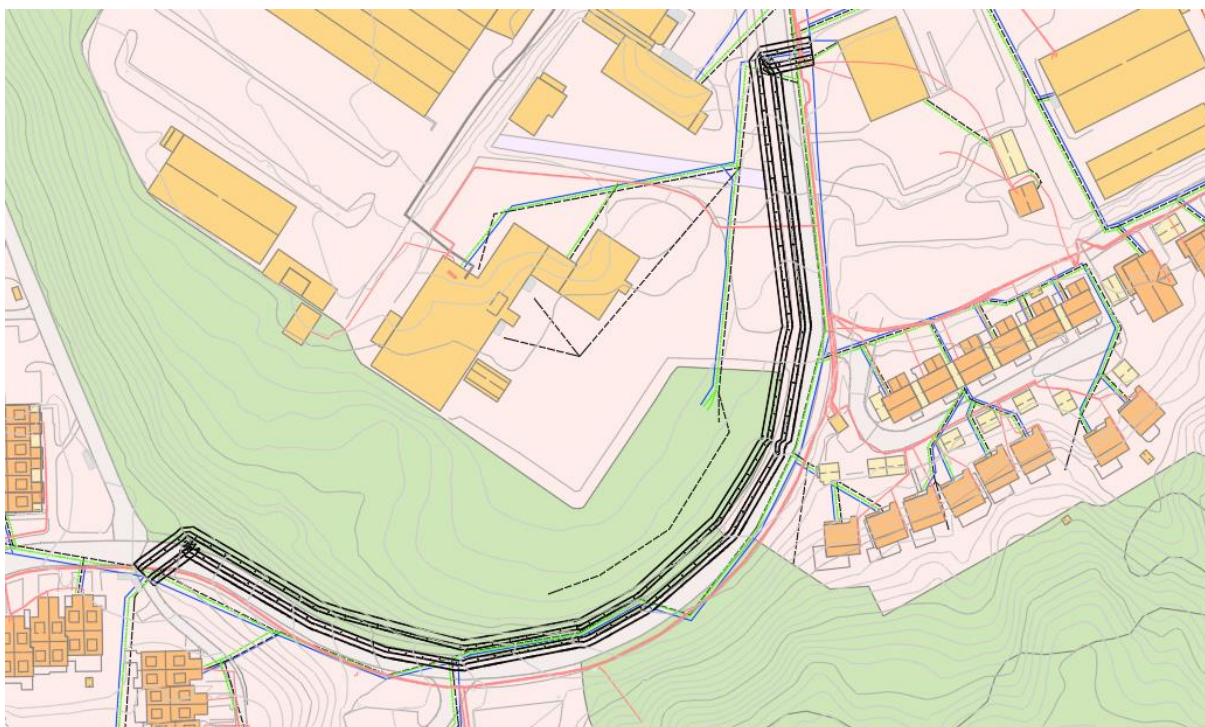
Figur 5.37. Skjerm bilde fra AutoCad. Tegning av grøft ved konvensjonell graving i Nordslettvegen
