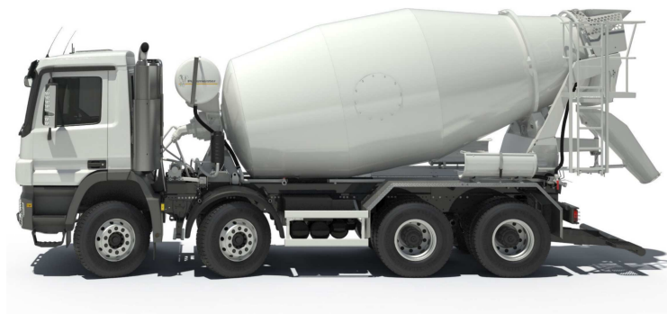
Figur 5: Eksempel på en betonglastebil [14].
