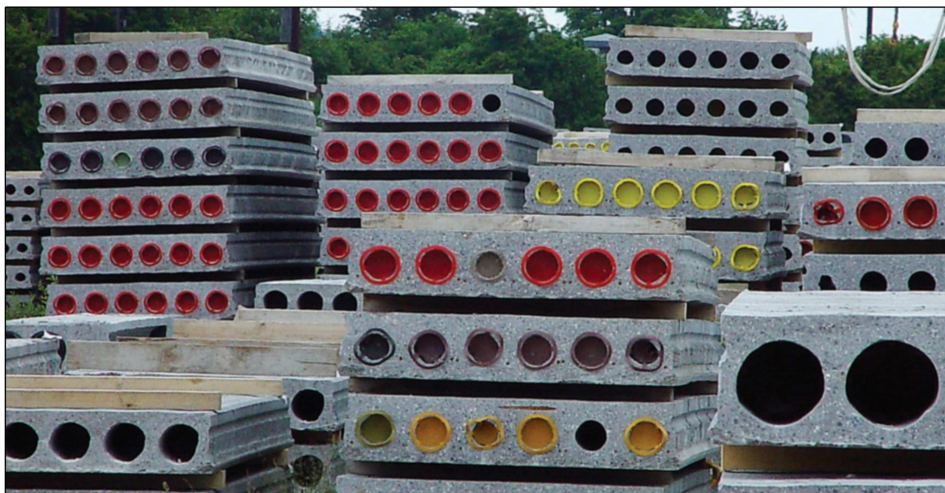
Figur 9: Eksempel på prefabrikkerte hulldekkeelementer [18, s. 104].
