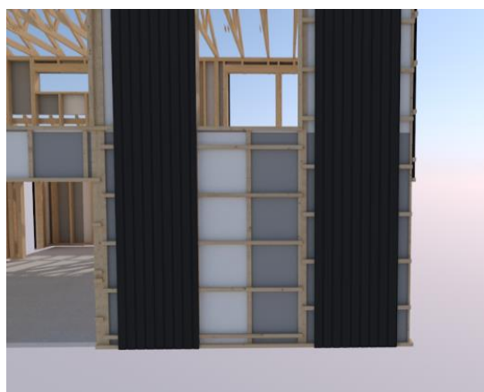
Figur 25: Feil på lektefunksjon, ArchiFrame
