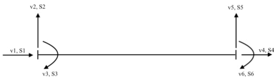
Figur 8.9 - Element med 6 frihetsgrader.
