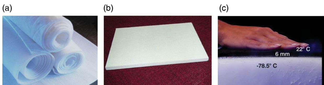
Figur 6: Aerogeler med fiberforsterkning. a) Aerogelmatte b) Aerogelpanel c) Aerogelmatte på tørris som illustrerer de gode isolerende egenskapene [29].
