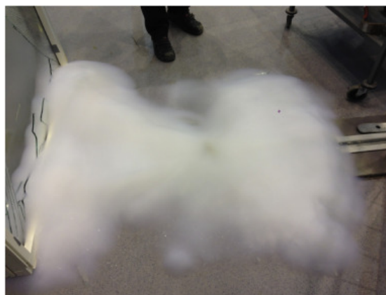
Figur 7: Et ødelagt vindu der aerogelgranulater er spredt utover et område [31].
