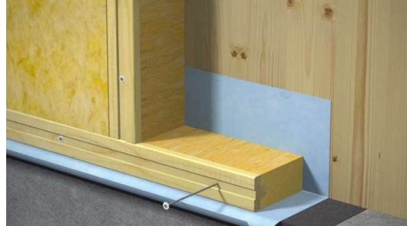
Figur 18 – Montering på massivtre [42]
