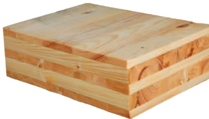
Figur 2 – Krysslagte elementer sammenføyd med lim [6]
