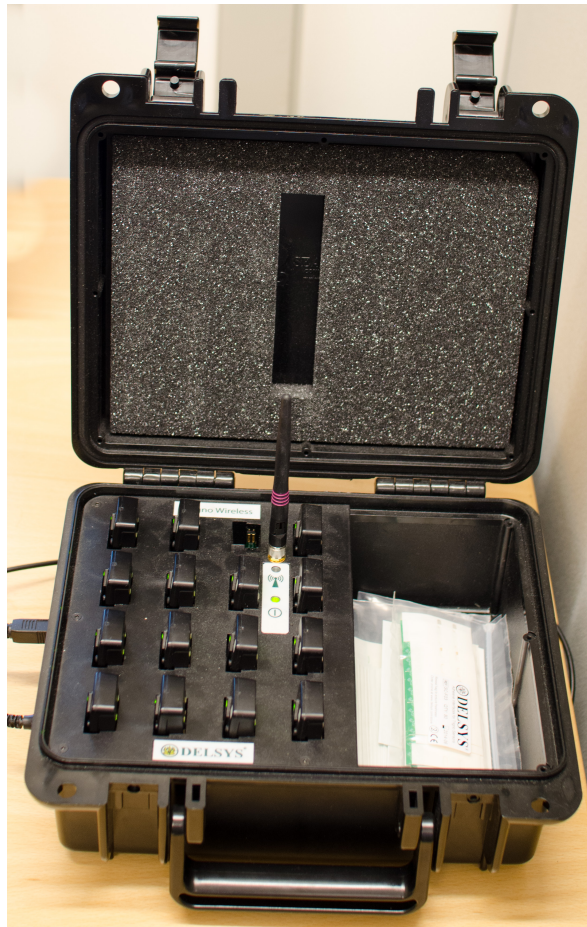
Figur 4: Et bilde av Trigno-sensorsystemet på ITK-laben. Modelldetaljer: FCC ID: W4P-SP-W01 (Sensor), W4P-SP-W02 (Basestasjon); IC: 8138A-DST01 (System)
