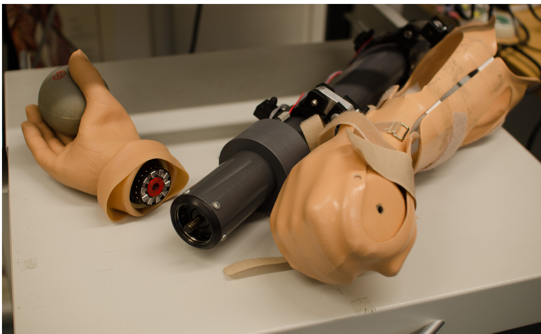
Figur 6: Bilde av en MC-protese og et rotasjonsledd, som er festet på en proteseholder. Protosemodellen heter ProHand og rotasjonsleddet heter ProWrist, og begge er levert av Motion Control.
