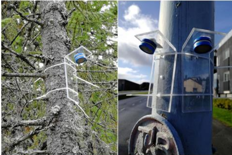
Figur 15 Oversiktsbildet som viser montering av passive prøvetakere på lyktestolpe(bildet til høyre) og trær( bildet til venstre) med strips. På lyktestolpen ble det montert to prøvetakere, mens på treet ble det montert en prøvetaker.
