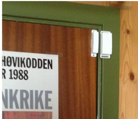
**Figure 11.5:** Magnet switch on bedroom door
