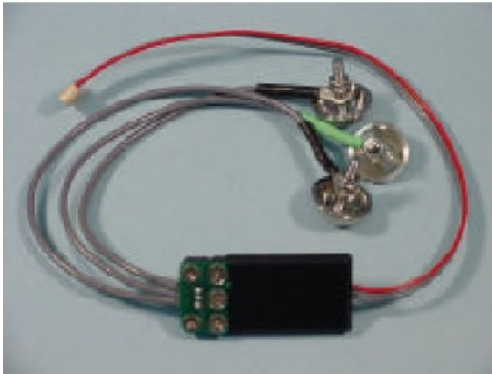
Figur 18: Pre-amp med eksterne elektroder fra LTI
