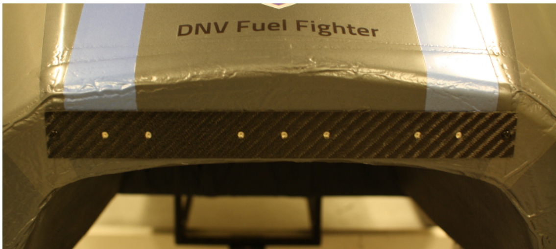
Figur 24: Baklys ferdig montert
