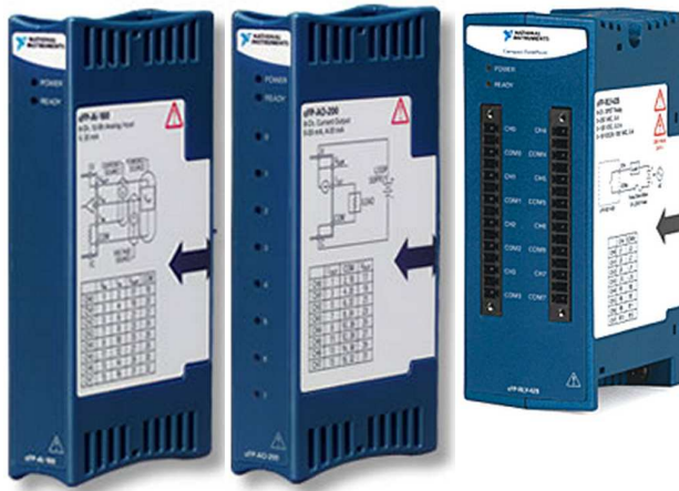
Figur 5.14: Analog inndata, analog utdata og relè modul
