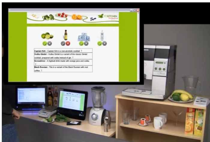
Figur 2.8.: Oppsettet «CocktailCompanion» nyttar for å hjelpa med drink-miksing. Til venstre i biletet kan ein sjå vekta som blir nytta og skjermen som viser oppskrifter. Til høgre, oppå hylla, står kaffimaskinen systemet nyttar. Skjermbilete frå video på [28].
