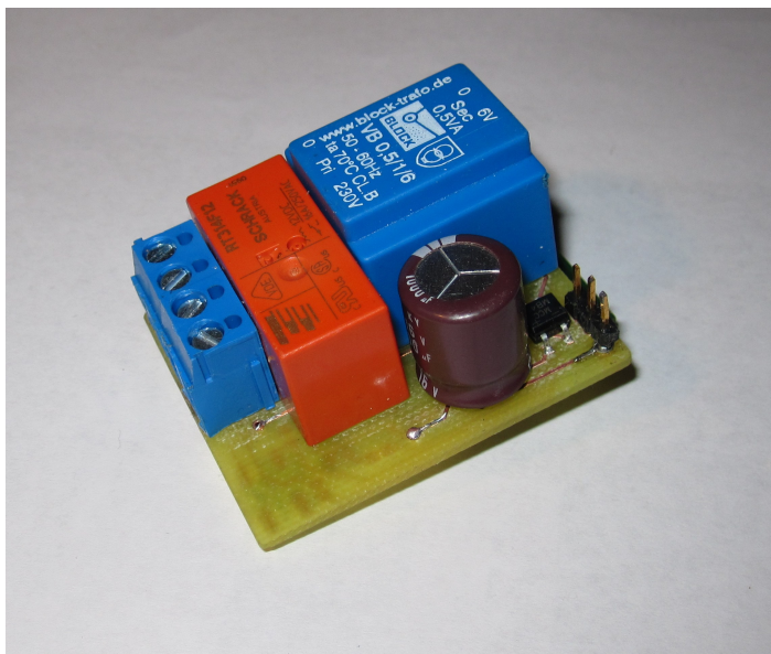
Figur 5.5.: Framsida av relénoden.
