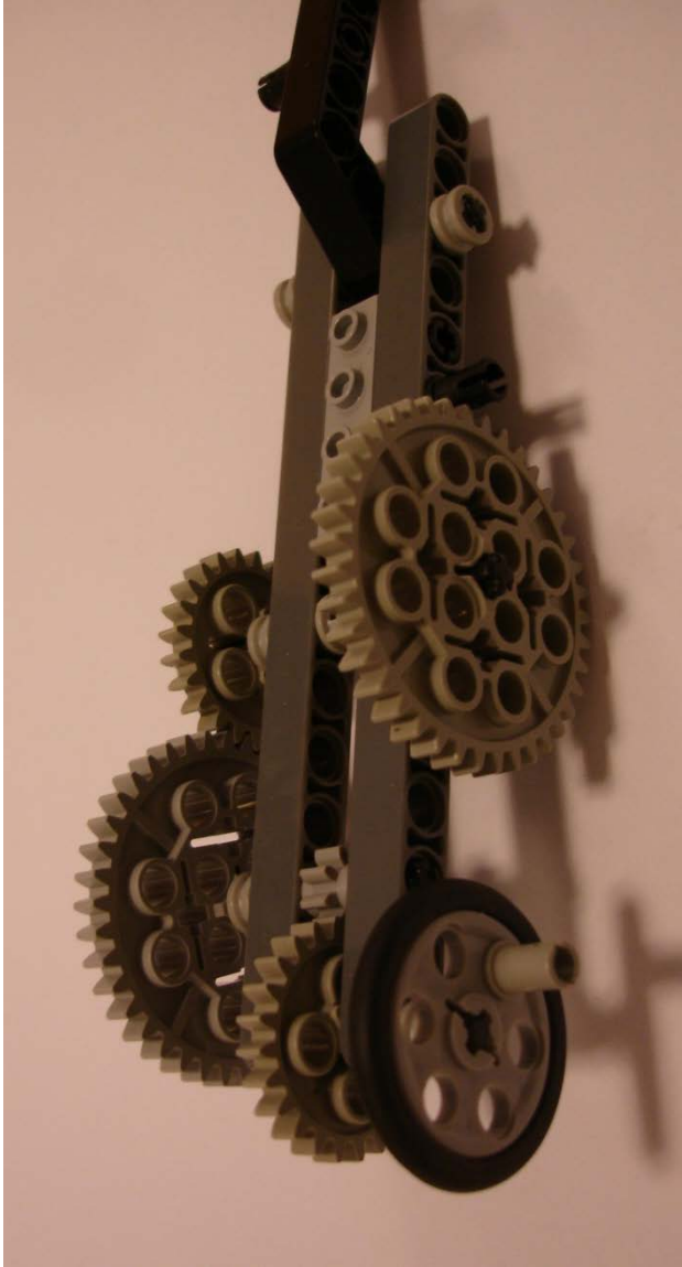
Figur 11: Utkast til slepehjul med gir, der optokobleren ville talt "tikk" på det store tannhjulet øverst
