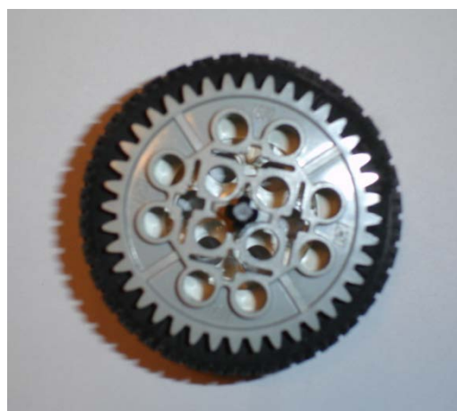
Figur 10: Større hjuldiameter sikrer tilstrekkelig klaring mellom tannhjul og bakken
