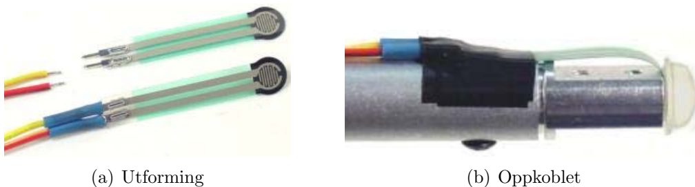
Figur 4.22: (a) og (b) gir et bilde av Interlink Electronics sin kraftfølende sensor (FSR).
