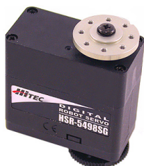
Figur 4.5: Hitec HSR-5498SG servo til underarm -supinasjon/pronasjon
