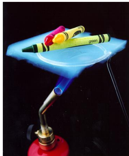
(b) Aerogel er tilsvarende ikke varmeledende p.g.a. sin lave vekt.
