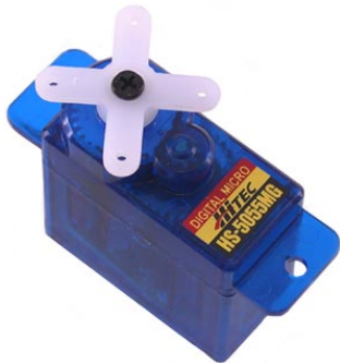
(a) Hitec HS-5055MG servo til Tommel -fleksjon/ekstensjon i håndflatens plan
