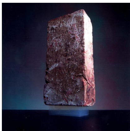
(a) Aerogel bærer vekten av en murstein
