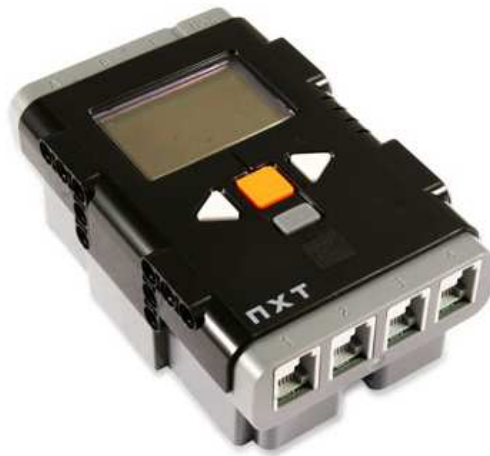
Figur 4.1: Figuren viser valgt maskinvareplattform fra LEGO, LEGO Mindstorm NXT 2.0.
