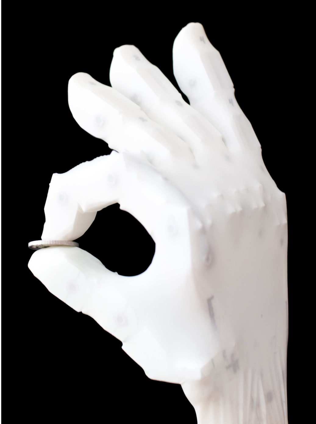
Figur 6.7: Utformet sammensatt prototype håndprotese med lateks hanske som “hud”. Her demonstreres effekten av fingerkrumming med aktuatortrekk via sene.
