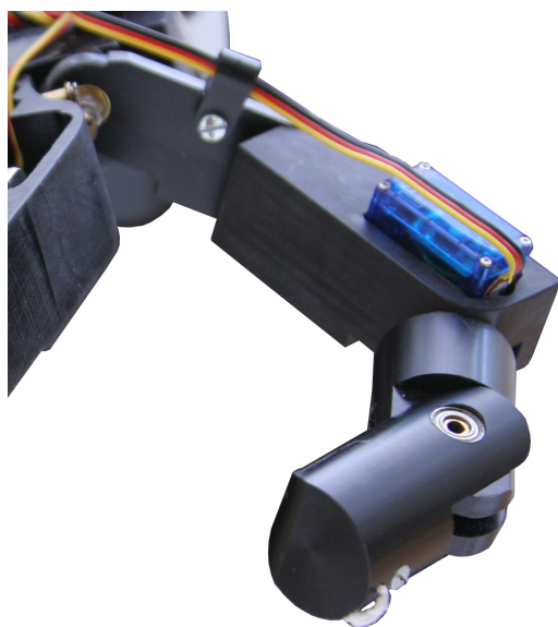
Figur 6.13: Tommeldesignet med fleksjon/ekstensjon likner iLimb ved at det ytterste leddet flekser ved at en sene holdes igjen når det innerste leddet roterer. Ab/Adduksjon sørger en egen servo for. Denne servoen har fått aksselfeste i overkant av servoen slik at det ikke er akslingen alene som bærer vekten av en last på tommelen.
