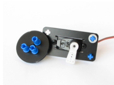
(b) RC Mini-Servo (9 grams). Kjørespenning: 4.6 – 4.8V, Momenttap av løfteevne: 6.0v > / = 1.4kg.cm 4.8v > / = 1.3kg.cm, kjørehastighet 6.0v: 0.14sec/60, kjørehastighet ved 4.8v: 0.17sec/60. Servo
