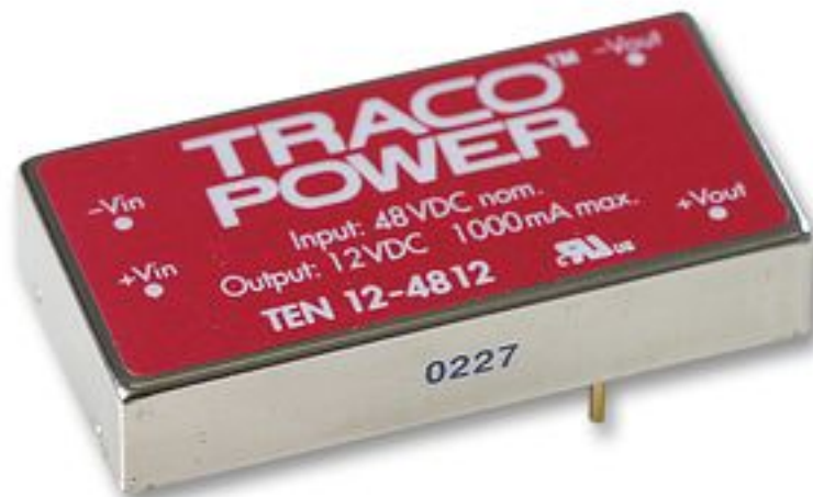
Figur 42: Traco DC-DC omformer med 18-75V inngang og 12V utgang. Omformeren tar strøm fra brenselcellen og er spenningsforsyning for kjøleviften til brenselcellestaken.
