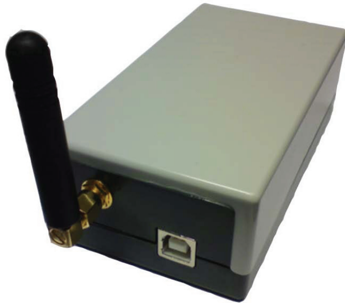
Figur 29: Telemetri-modulen i lukket boks med mobilantenne og USB-kontakt
