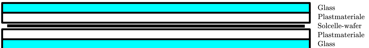
Figur 20: Tverrsnitt av sandwich med glass, plastmateriale og wafere.
