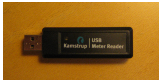
Figur 4.13: Kamstrups USB Meter Reader som brukes for å laste ned energibruk fra fjernvarmeanlegget.
