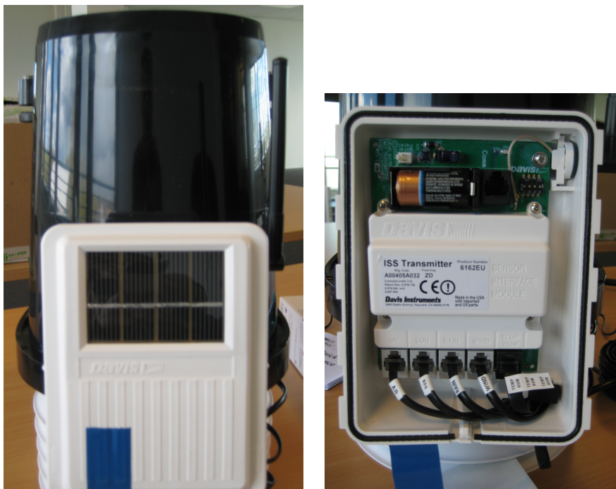
(a) SIM påmontert kjerneenheten til ISS. (b) Innsiden av SIM, hvor alle sensorer kobles til.
