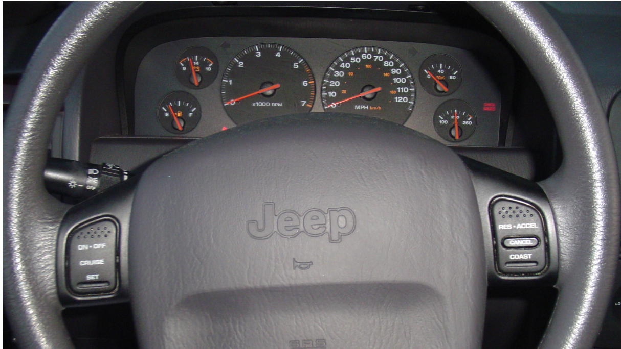
Figur 4 Cruise Control i Jeep Grand Cherokee Laredo. (Bildet hentet fra Wikipedia, og er under GNU Free Documentation License.)
