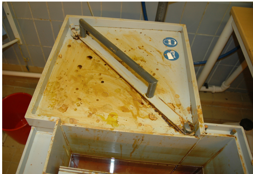
Figur 19 Oppvarmet syrebad for å etse vekk kobber
