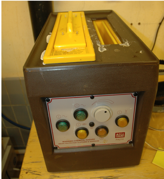
Figur 18 Lutbad for å vaske bort belyst belegg
