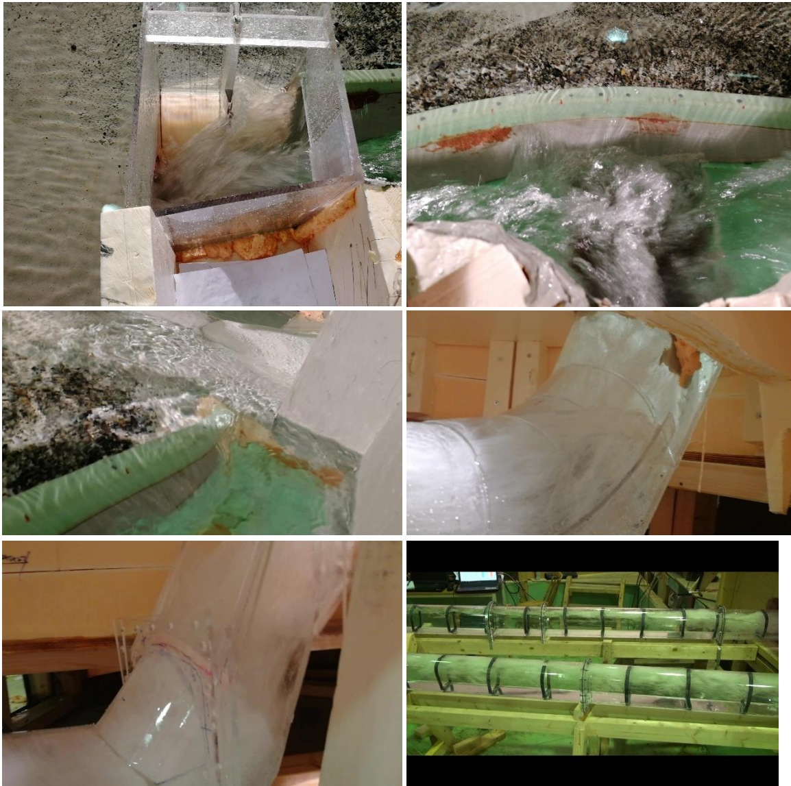
Figur 63 - Bilde av lukehus, sidekanal, ny og eksisterende sjakt og ny og eksisterende tunnel ved Q_{PMF} med begge lukene stengt.
