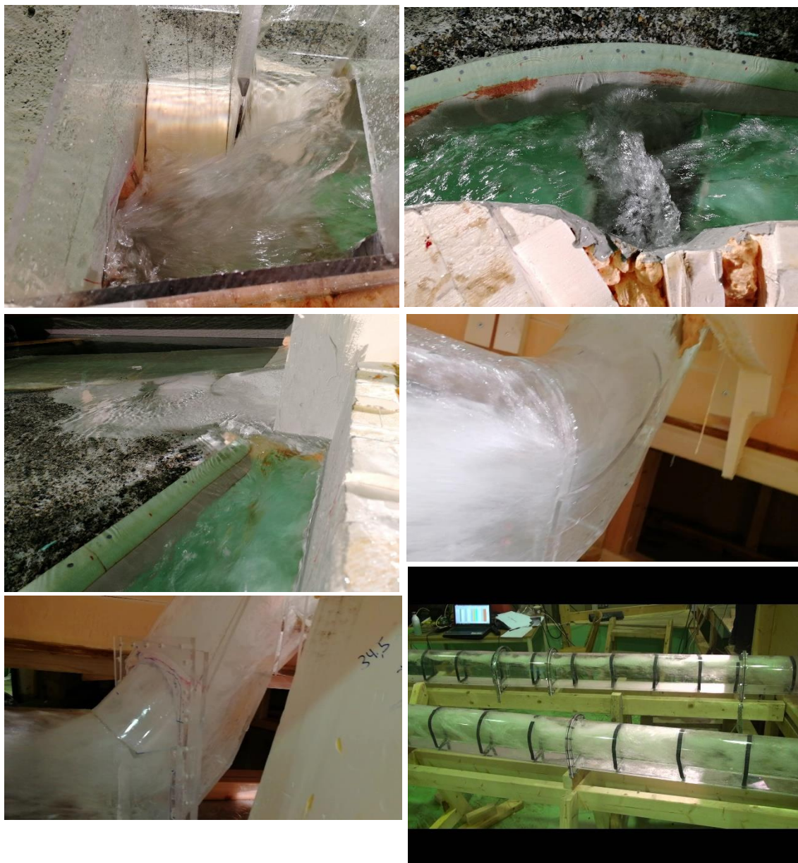
Figur 64 - Bilde av lukehus, sidekanal, ny og eksisterende sjakt og ny og eksisterende tunnel ved Q_{PMF} med høyre luke åpen.
