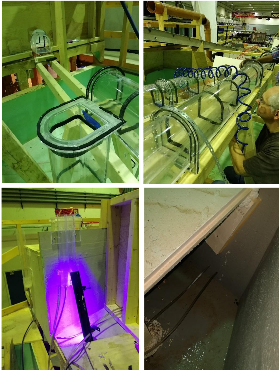
Figur 66 - Bilder av liming av tunnelseksjoner, montering av differensialtrykkmåler og installering av stikkmåler for måling av vannstand.
