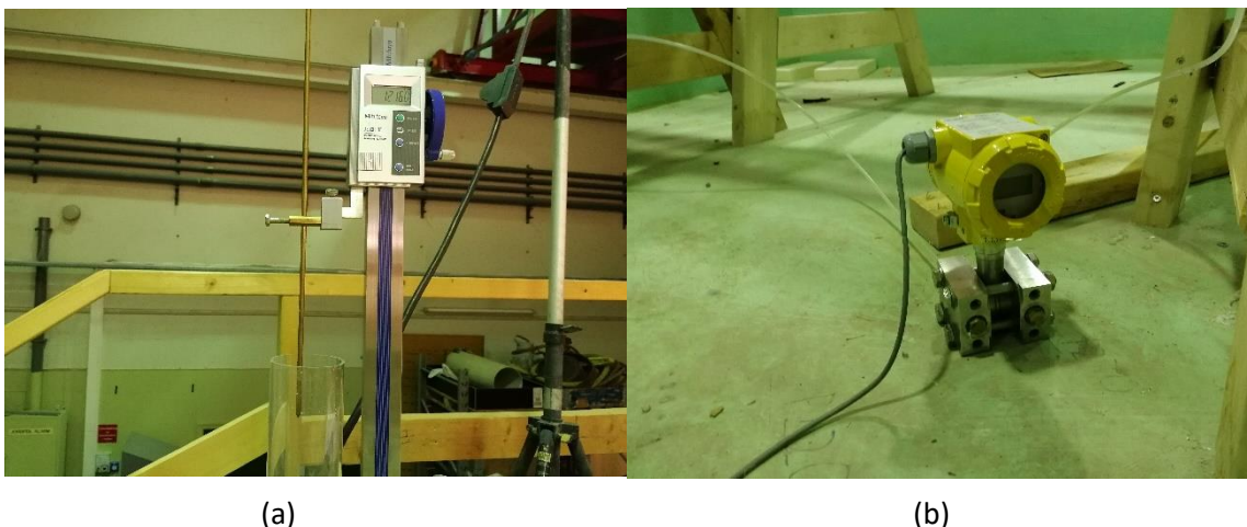
Figur 22 - Stikkmåler for måling av vannstand (a) og differensialtrykkmåler (b).
