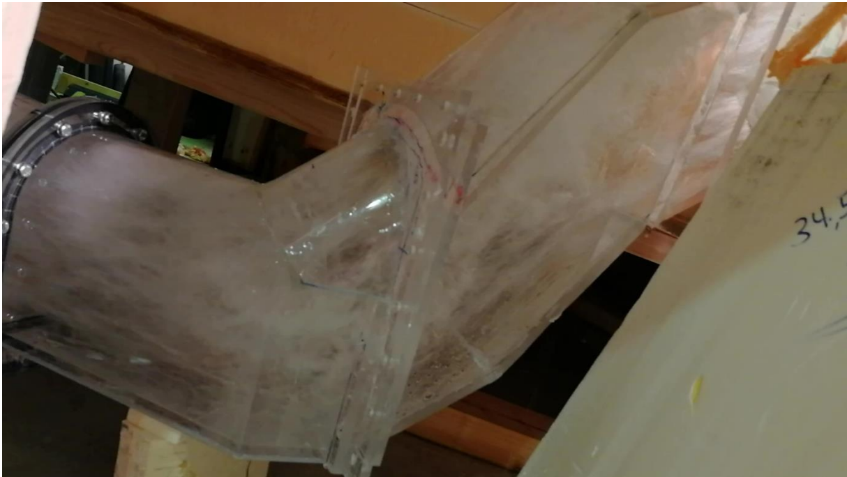
Figur 40 - Strømningen i eksisterende sjakt ved Q_{PMF} med begge lukene åpne.
