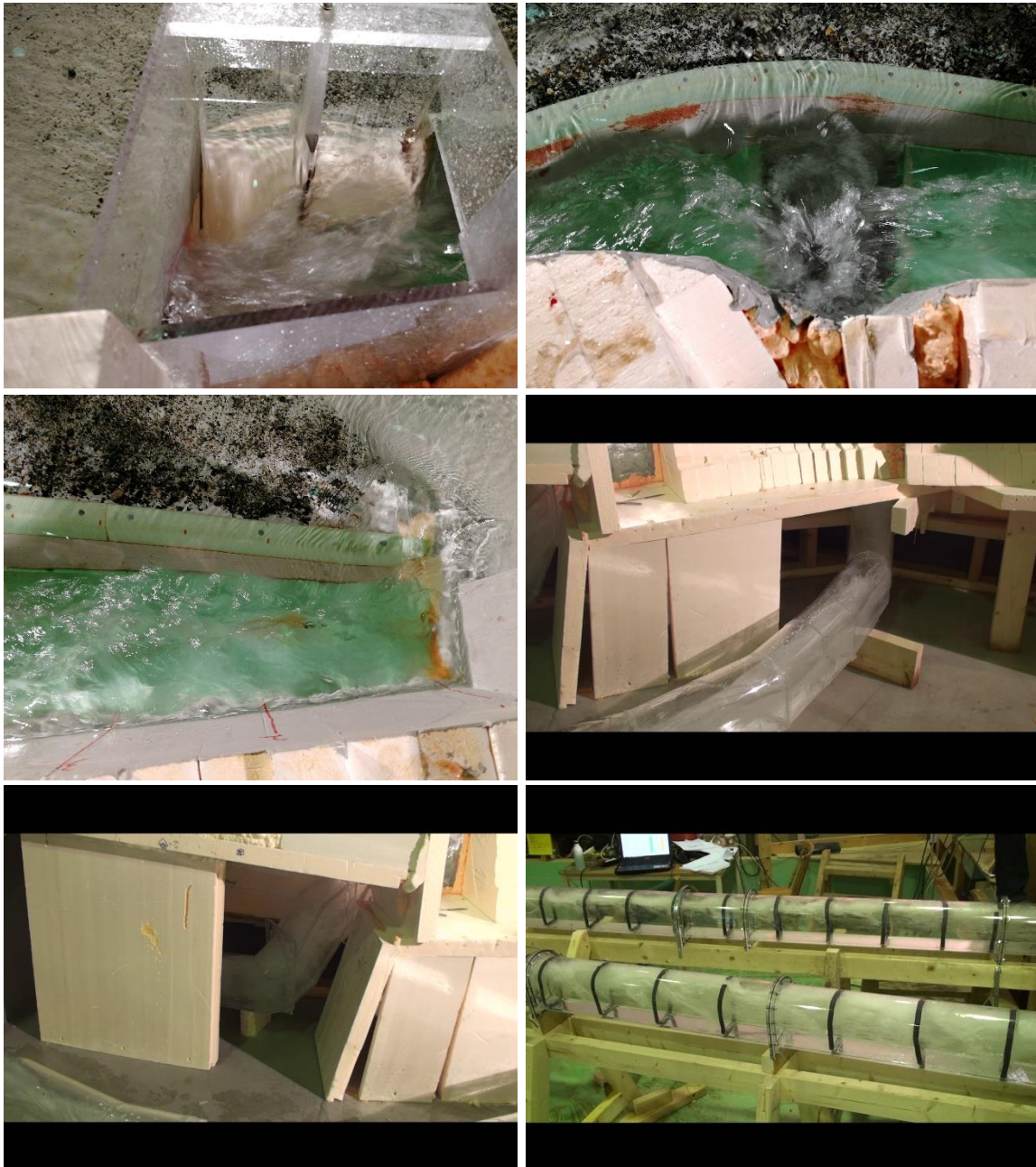
Figur 65 - Bilde av lukehus, sidekanal, ny og eksisterende sjakt og ny og eksisterende tunnel ved Q_{PMF} med venstre luke åpen.
