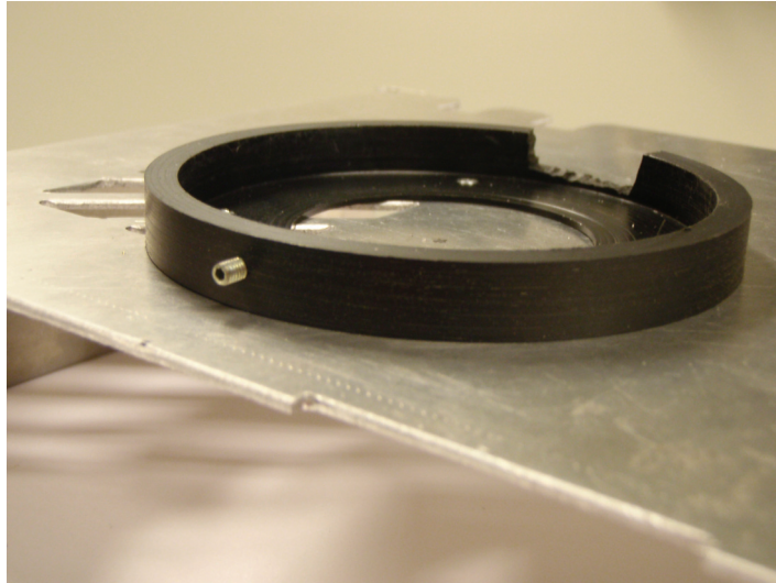
Figur 3.11: Fleksibelt feste for posisjoneringstårn på toppen av roboten
